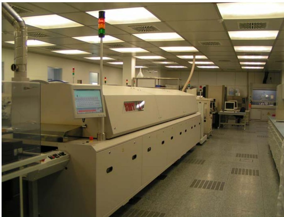
Freescale Testlabor: SMD-Linie mit der Reflow Lötanlage SMT Quattro Peak L Plus
